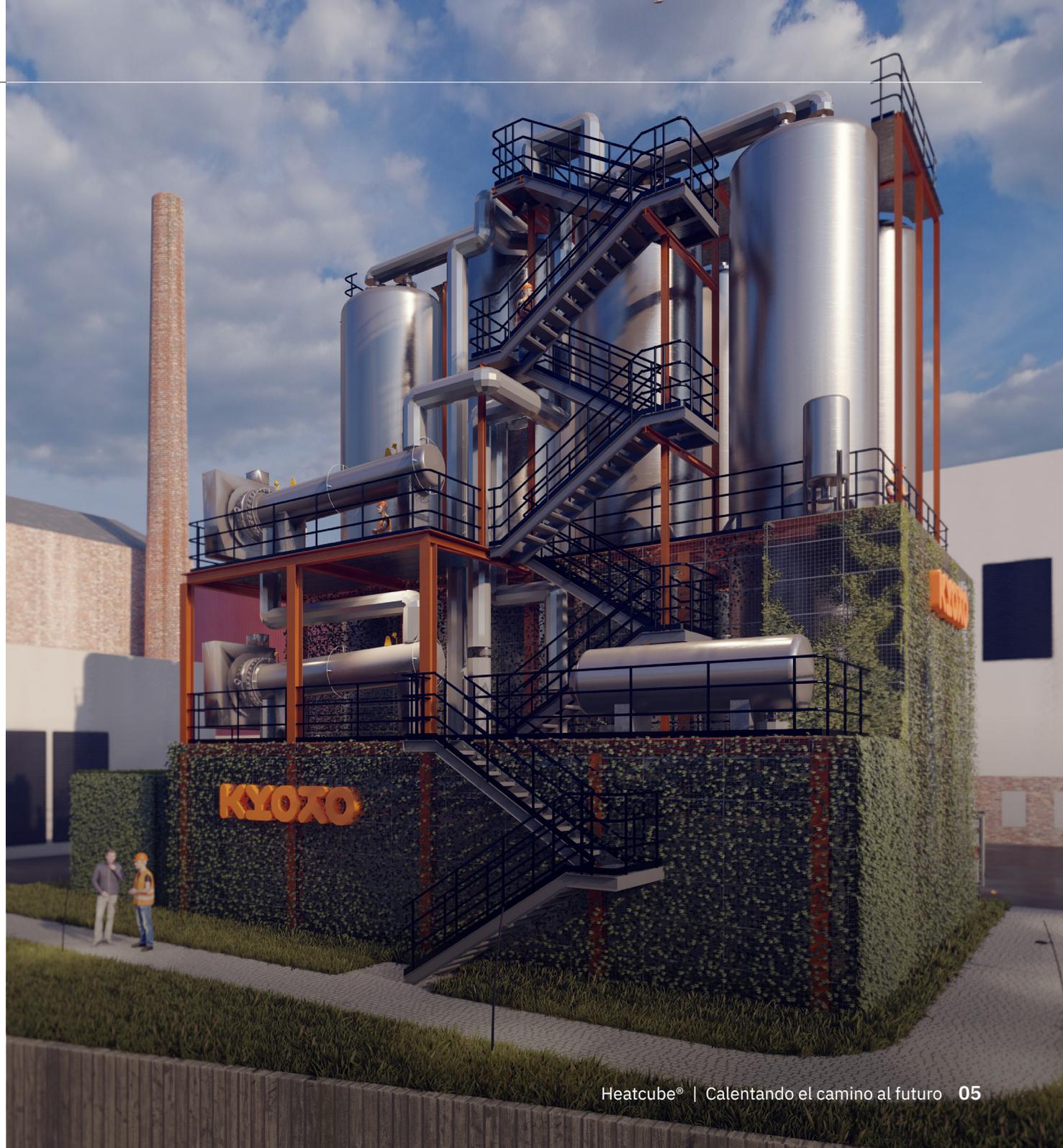
El Heatcube es un sistema de almacenamiento de energía muy flexible y multifuncional diseñado para suministrar calor «a la carta» para aplicaciones industriales. El Heatcube se puede adaptar a medida para optimizar el rendimiento según la demanda térmica necesaria empleando tres componentes principales para la carga, el almacenamiento y la descarga.
